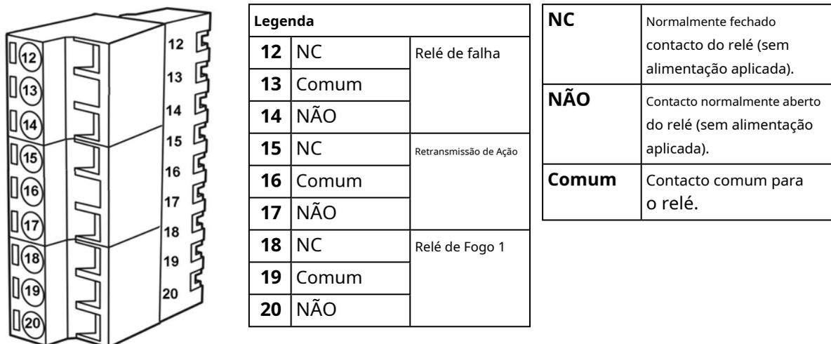
Figura 2-12: Visualização do bloco de terminais, relés
