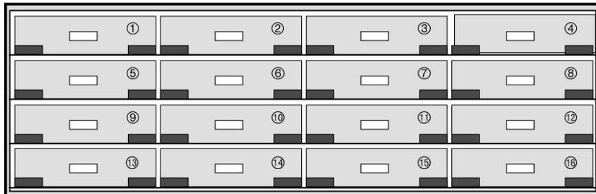
6. Insira um HDD numa das respetivas baías até ficar perfeitamente encaixado na respetiva posição. Repita o procedimento com os restantes HDD.
