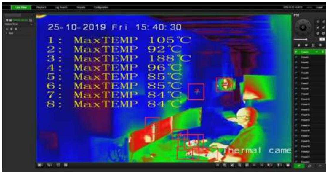
Figura 35: O exemplo de ponto de combustão resulta numa janela de visualização em direto
