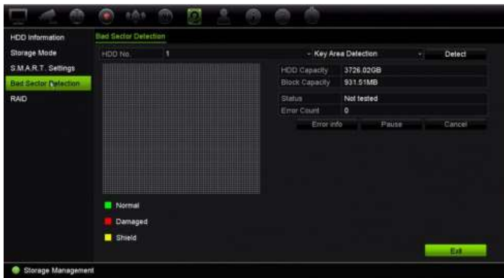
Figura 33: Janela de deteção de setor danificado
