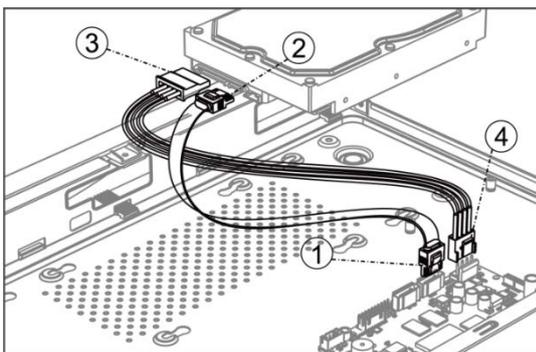
5. Certifique-se de que o disco rígido está alinhado com os orifícios na parte inferior do gravador. Fixe o disco rígido com os parafusos.
