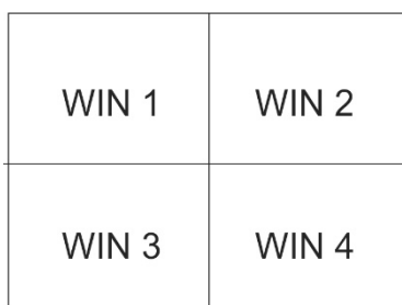
Figura 17: Exemplo de uma disposição de mosaicos de vídeo (WIN) em ecrã dividido 2*2
