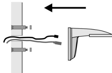
5. Para concluir a instalação da câmara, consulte as Instruções de Instalação relativas à câmara específica.
