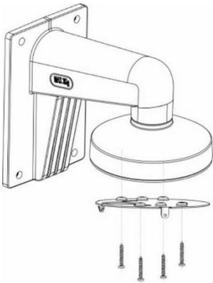
7. Passe os cabos da câmara através da placa adaptadora. Caso não sejam utilizados todos os acessórios/cabos, estes podem ser arrumados atrás da placa adaptadora para que não interfiram com a instalação da câmara no suporte de parede.
