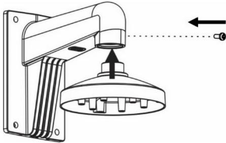
6. Coloque a placa adaptadora no suporte de parede com base tipo copo. Antes de instalar a placa adaptadora, certifique-se de que a câmara fica corretamente orientada quando for montada na placa adaptadora. Com o parafuso A, fixe a placa adaptadora ao suporte de parede.
