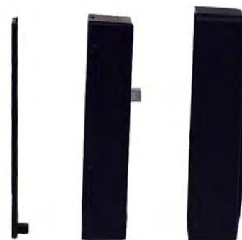
Figura 2. Placa base, gabinete do leitor e cobertura superior.
