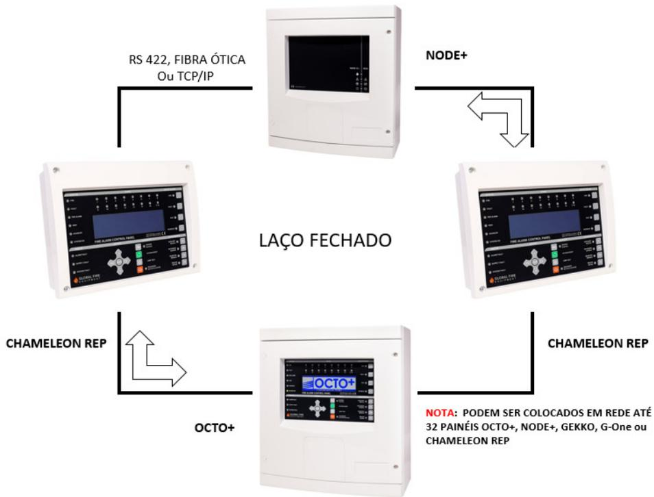
No entanto, ao ter ambos os canais CH1 e CH2 ocupados e ligados em anel de dados fechado, o CH3 extra (BMS) pode ser utilizado para se adicionar um “repetidor” como por exemplo um CHAMELEON DISPLAY.
