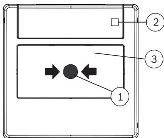
Ao premir a marca preta (1) quebra-se o vidro (3), accionando desta forma o alarme, colocando o indicador LED (2) a piscar.
