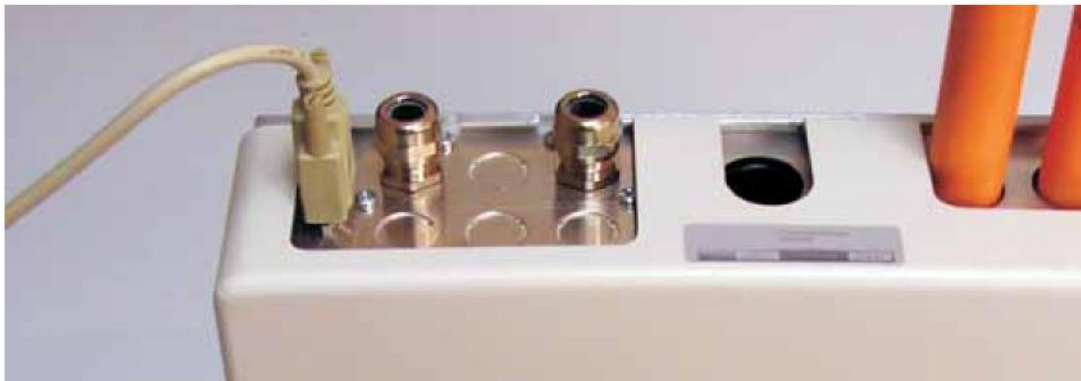
Figura 26: Ligar um PC à porta RS-232 do módulo de comando
