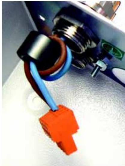
Figura 8: Enrolar cabos de ligação de relé em redor de uma ferrite de supressão
